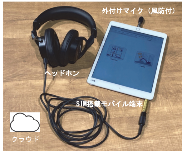
写真-2 システム機器（工事騒音評価時）
