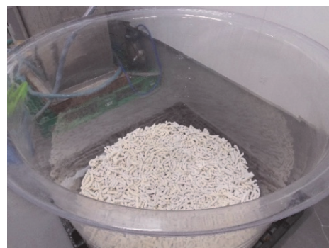
写真-1 水槽の底に敷いた多孔質担体
