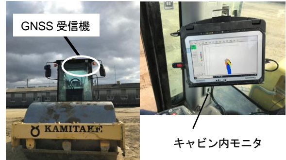
写真-5 締固め管理システム
