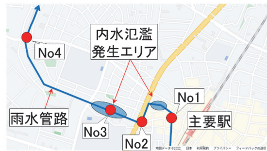
図-3 マンホールアンテナ設置箇所
