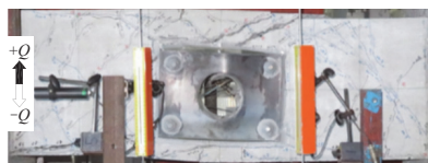
【 R=+30.0 \times 10^{-3} rad時】 写真-1 損傷状況の一例
