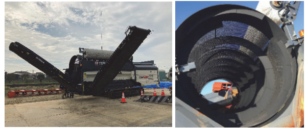
写真-2 TEREX 製 TTS620T (回転ふるい機 A)
