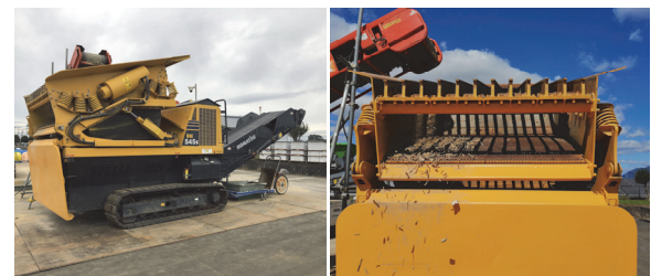
写真-5 コマツ製 BM545S (振動ふるい機)
