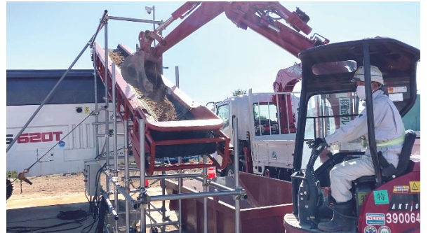
写真-7 模擬災害廃棄物投入状況
