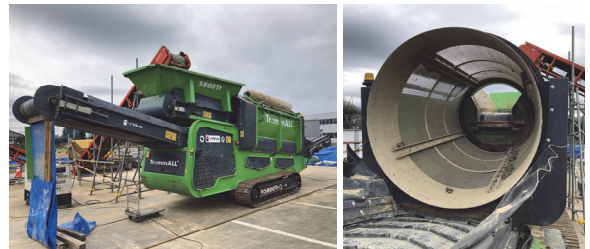
写真-4 TrommALL 社 5800Tr (回転ふるい機 C)
