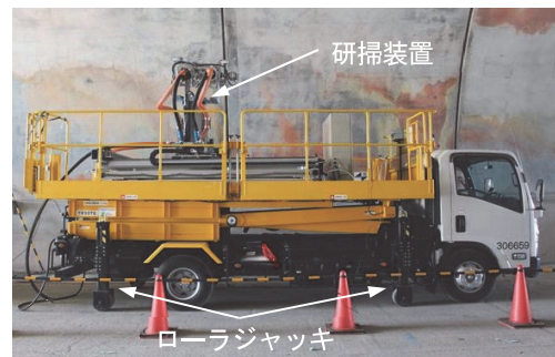
写真-5 荷台昇降車の外観（研掃装置積載）
