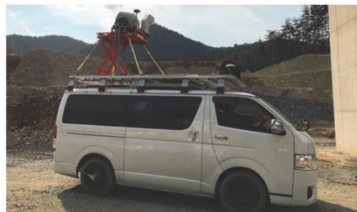
写真－1 工事用道路走行用 MMS
