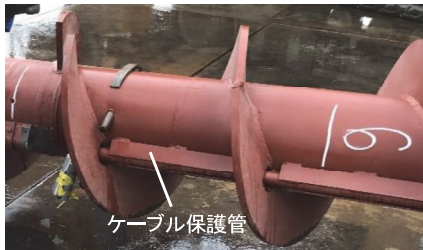
写真-2 ケーブル保護管付属スクリーオーガー
