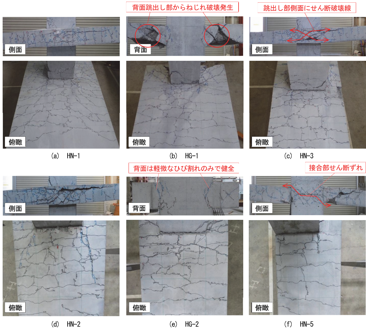
写真-1 最終破壊状況
