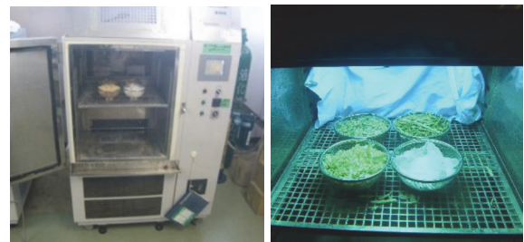
写真-6 促進耐候性試験機 写真-7 試験状況
