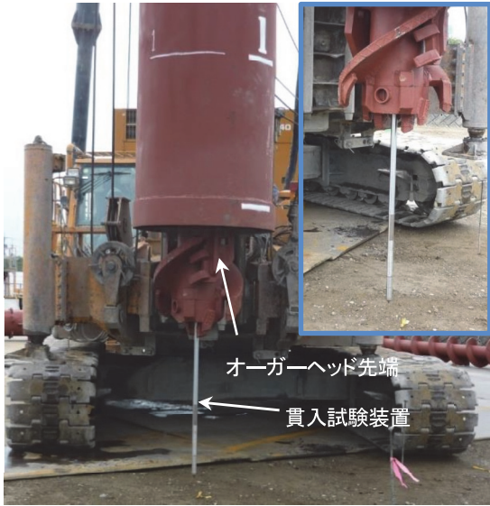
写真-1 貫入試験装置動作確認状況 (右上: ロッド部拡大)
