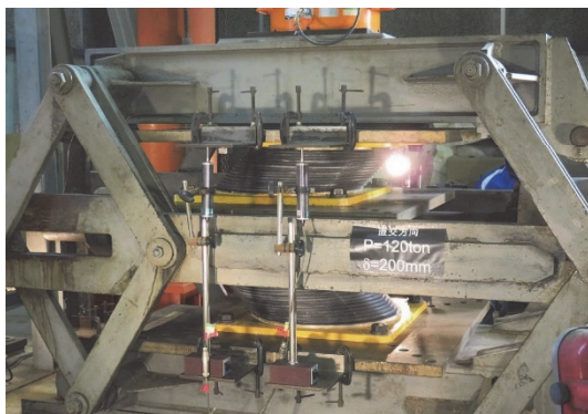
写真-2 圧縮せん断試験の状況
