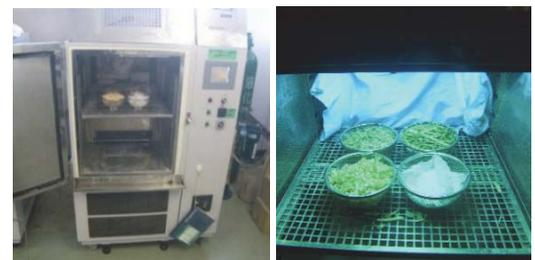
写真-2 促進耐候性試験機と試験状況
