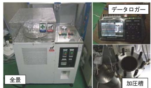
写真-1 亜臨界水処理装置
