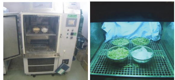
写真-6 促進耐候性試験 写真-7 試験状況
