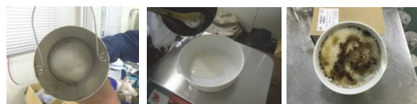
処理前 処理後 乾燥後 写真-5 吸水性樹脂の高温高圧処理状況
