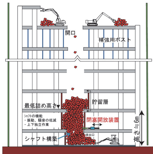
図-1 工法の概要
