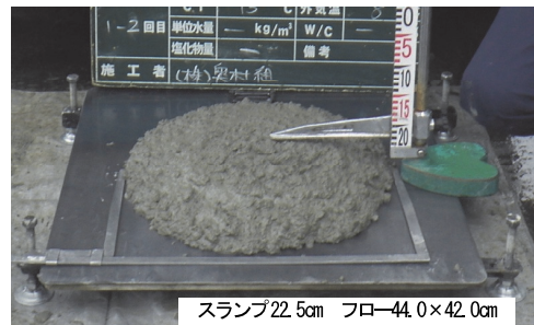
写真-1 フレッシュ試験の状況
