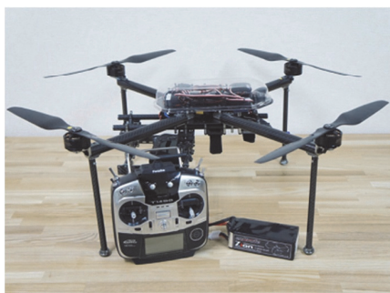
写真一 1 UAV 測量装置
