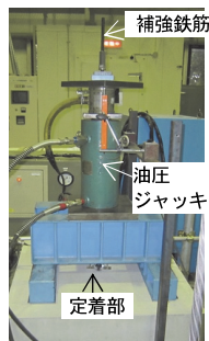
写真-1 引抜き試験状況
