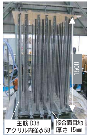
写真-1 実大試験体
