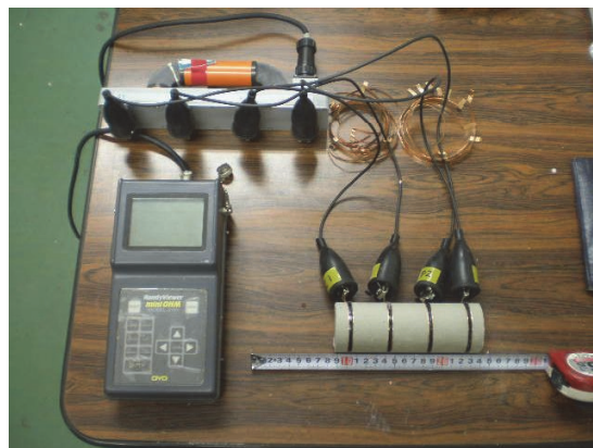
写真-1 改良地盤の比抵抗測定状況
