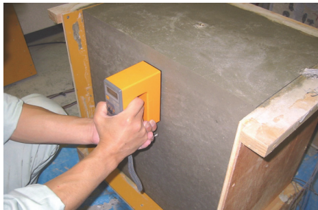
写真-4 コンクリートの表面含水率測定状況
