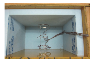
写真-3 埋込み型ひずみゲージと熱電対
