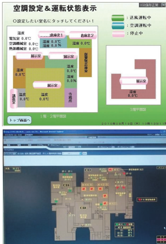
図-13 エネスケールの操作画面(上)と既設中央監視制御システムの操作画面(下)
