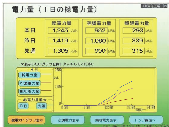
図-14 過去電力量の比較とトレンドグラフ表示画面
