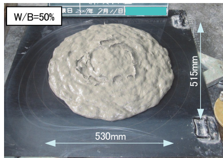
写真-2 スランプフロー試験状況例
