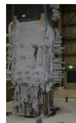
(c) ひび割れ注入
