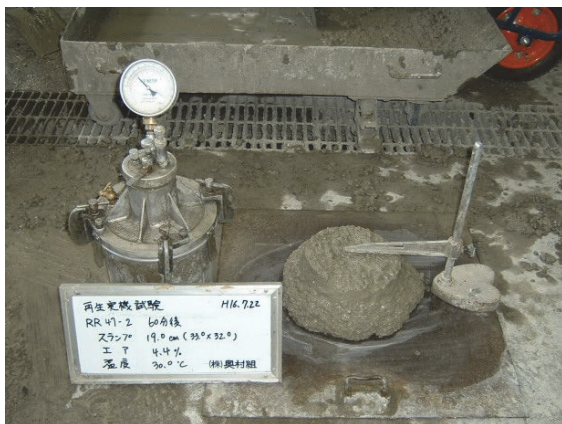
写真-1 RR47w調合の60分後のフレッシュ状況
