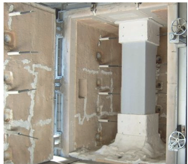
写真-4 荷重加熱試験準備状況
