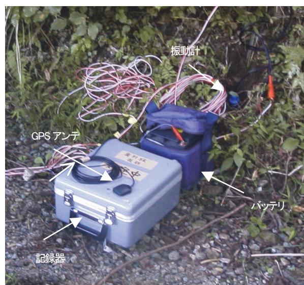
写真一1 測定機器の設置状況
