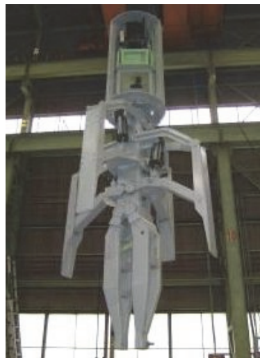
写真-5 煉瓦解体機 (工場完成時)
