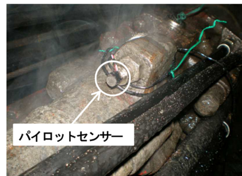
油圧ドリフタに設置したパイロットセンサー
