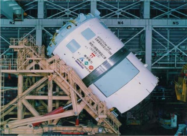
全断面斜坑TBM傾胴(勾配 48 度)
