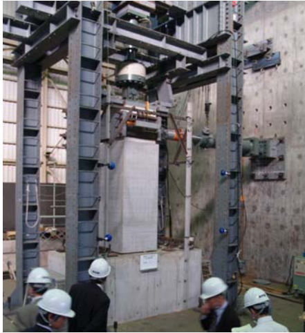
交番載荷試験状況
