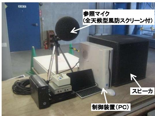
写真-1 アクティブ消音システムの構成機器
