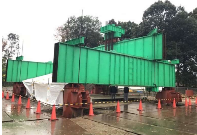
写真1 構造性能を確認するための載荷試験状況
