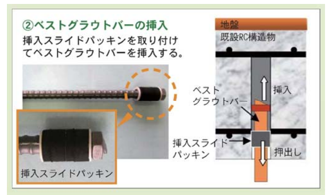
図-3 鉄筋挿入治具と挿入作業の概要
