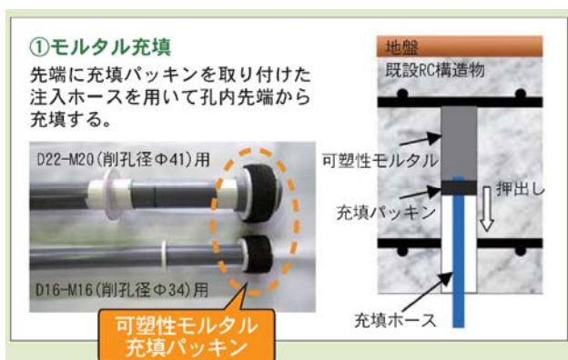
図-2 モルタル充填治具と充填作業の概要
