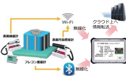
遠隔計測装置の仕組み
