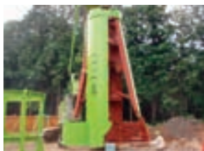
新OMR/B掘削機 (軸部径 \phi 2,100\text{mm} 、拡底部径 \phi 4,700\text{mm} )
