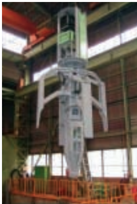
煙突解体機全景
