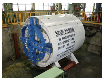
写真-3 やどかり君工法用掘進機
