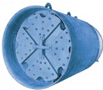
写真3 初期の泥水式シールドマシン(1964)
