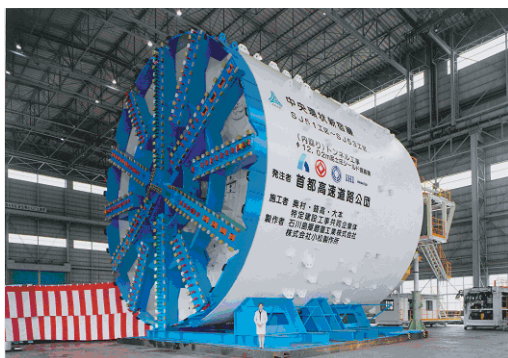
写真4 最近の泥土圧式シールドマシン(2003)
