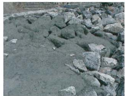
▲ 大粒径粗骨材中に充填された SCC
