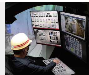
シールドマシン遠隔操作状況①
