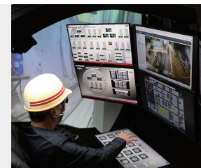
シールドマシン遠隔操作状況①
