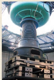
灯台レンズ用免震装置
