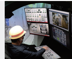
シールドマシン遠隔操作状況①
