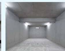
床衝撃音・固体伝搬音を検証できる「床衝撃音実験室」(写真は、同実験室内の「壁式構造箱型実験室」)
