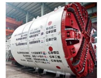
地下鉄用泥水圧式シールド機(中国)
