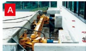
自由振動実験装置(20トンジャッキ・2基)
