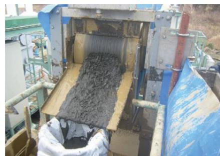
磁力選別機による鉄粉の回収状況
