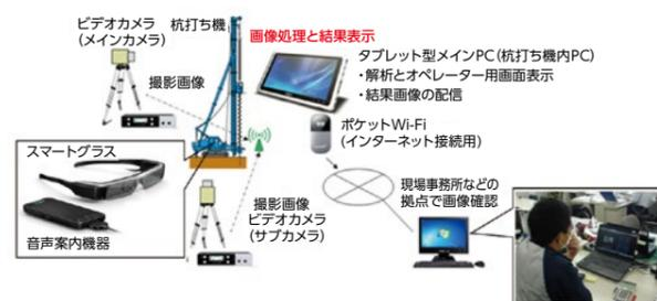
画像解析による杭の施工管理システムの全体構成
