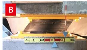
免震装置(積層ゴム)の変形状況
