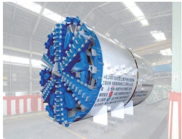
遠隔操作したシールドマシン
