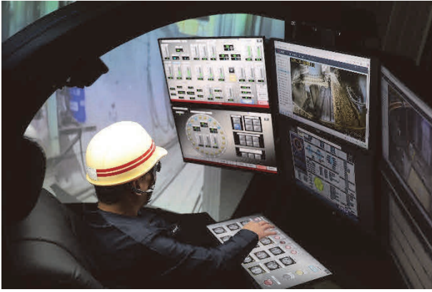
シールドマシン遠隔操作状況(日本側)
