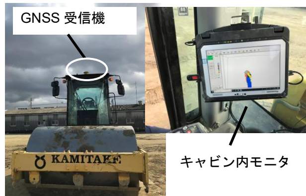
図 37 締固め管理システム搭載振動ローラー
