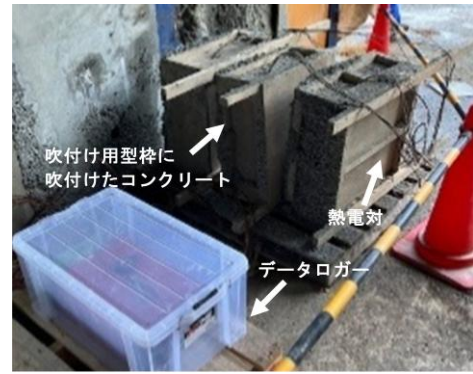
写真-2 温度履歴の測定状況
