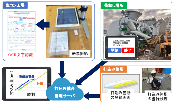
図-4 打込み段階での使用イメージ
