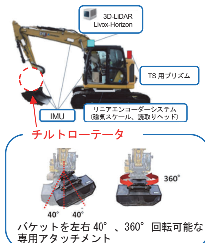
図－1 自動化した油圧ショベル
