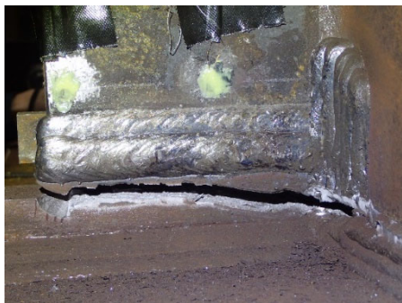
(e)+10 サイクル<破断> (東ダイアフラム側)
