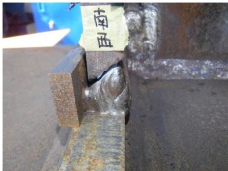
(e)－19 サイクル<破断前のピーク> 南西溶接部
