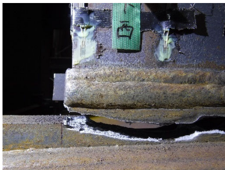
(e)-11 サイクル<破断> (西ダイアフラム側)
