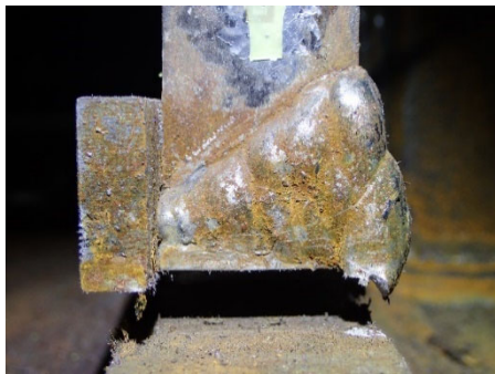
(c)+1 サイクル<破断> (西ダイアフラム側)
