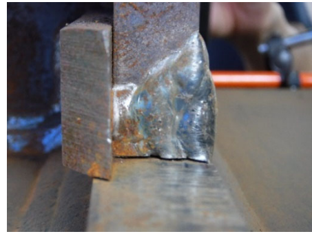
(b)+5 サイクル<板厚貫通> 南東溶接部
