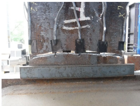
(g)+13 サイクル<破断> 東面溶接部
