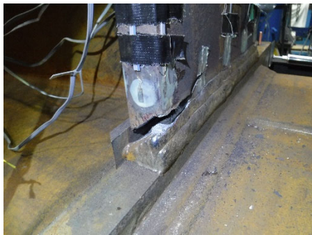
(c)+18 サイクル<破断前のピーク> (東フランジ側)
