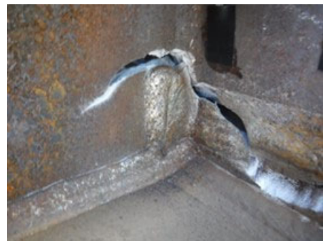
(h)+16 サイクル<破断> 南東フィレット部
