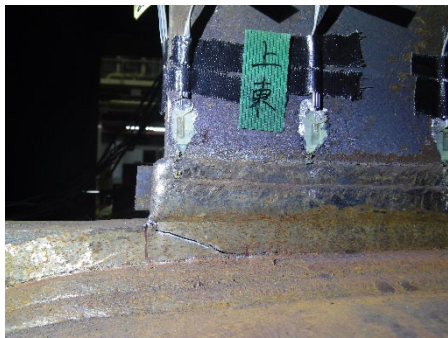
(c)+2 サイクル<破断> (東ダイアフラム側)
