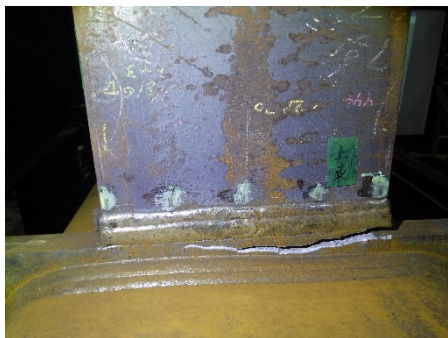
(e)+4 サイクル<破断> (ダイアフラム側)
