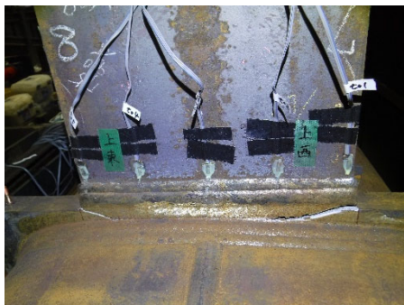
(g)+2 サイクル<破断> (ダイアフラム側)
