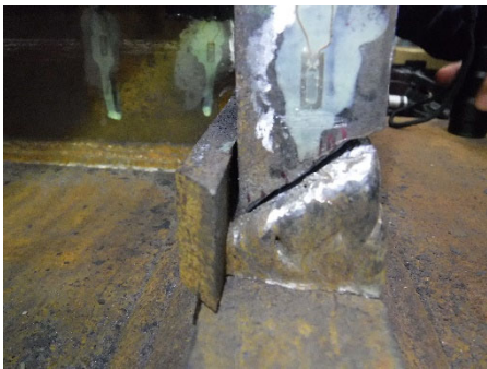
(c)－21 サイクル<破断前のピーク> (東フランジ側)
