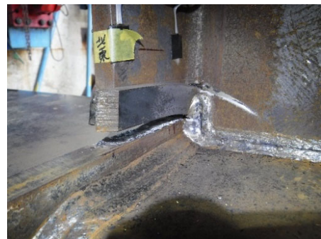
(h)+23 サイクル<破断> 北東溶接部
