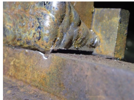
(d)-2 サイクル<幅方向亀裂> (東ダイアフラム側)
