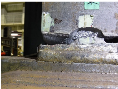
(e)+18 サイクル<破断前のピーク> (東フランジ側)
