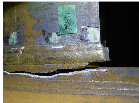
(d)+4 サイクル<破断> (東ダイアフラム側)
