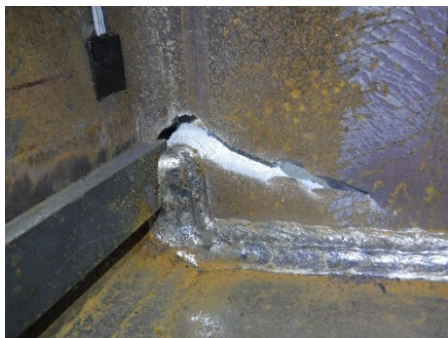
(g)+20 サイクル<破断> 北東フィレット部
