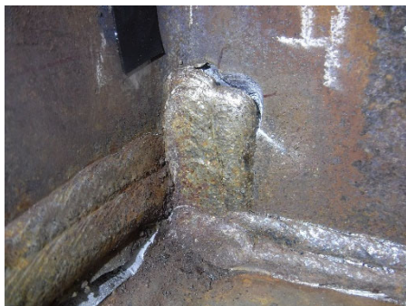
(e)－13 サイクル<破断前のピーク> 南西フィレット部
