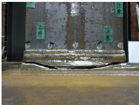
(g)+9 サイクル<破断> (ダイアフラム側)
