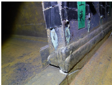
(e)+2 サイクル<破断> (東ダイアフラム側)
