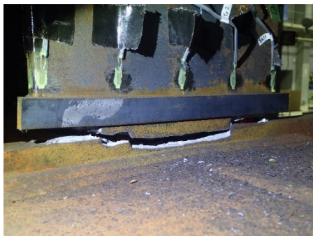
(e)-8 サイクル<破断> (ダイアフラム側)
