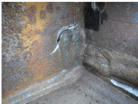
(e)+18 サイクル<破断前のピーク> 南東フィレット部
