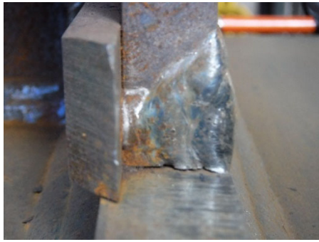
(a)+3 サイクル<亀裂発生> 南東溶接部
