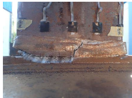
(f)+23 サイクル<破断> 東面溶接部
