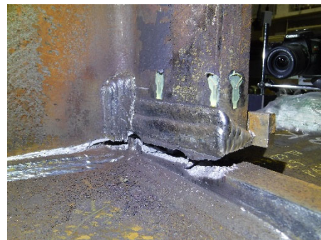
(h)+16 サイクル<破断> (西ダイアフラム側)
