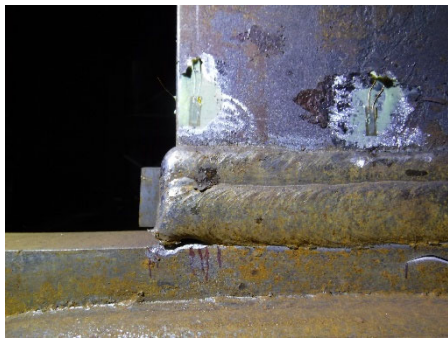
(c)+4 サイクル<破断> (西ダイアフラム側)
