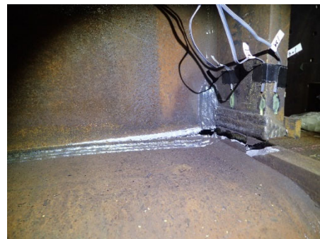
(f)+12 サイクル<破断> (西ダイアフラム側)
