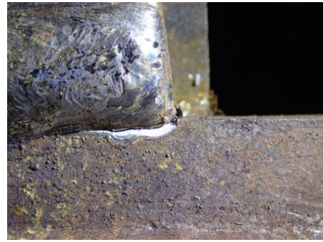
(b)+1 サイクル<破断> (東ダイアフラム側)
