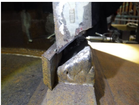
(e)－22 サイクル<破断> (東フランジ側)
