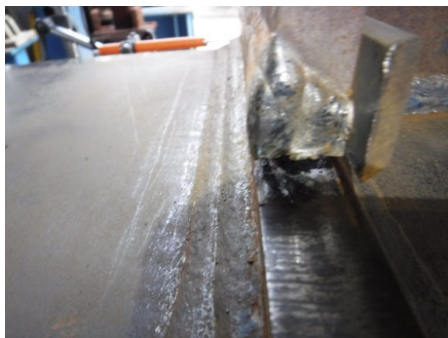
(e)+22 サイクル<破断前のピーク> 北東溶接部
