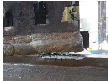
(d)+21 サイクル<耐力 10%減> 北東溶接部
