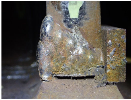
(a)+1 サイクル<破断> (東ダイアフラム側)
