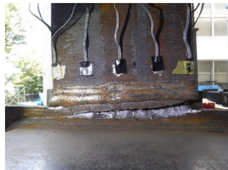
(h)+20 サイクル<破断> 東面溶接部
