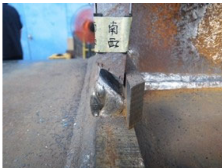
(e)－23 サイクル<破断前のピーク> 南西溶接部
