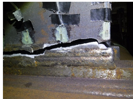
(h)－22 サイクル<破断> (西フランジ側)
