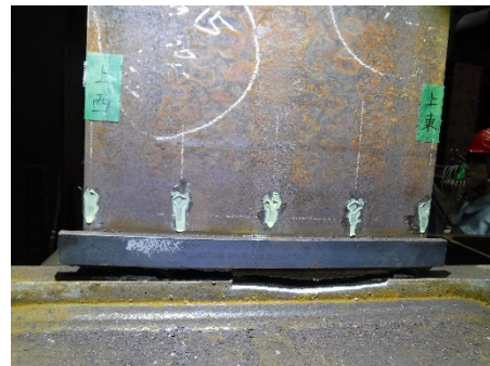
(d)+16 サイクル<破断> (ダイアフラム側)
