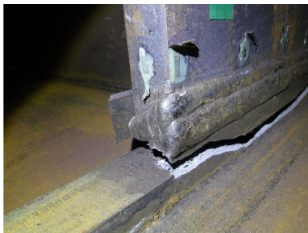
(e)+9 サイクル<破断> (西ダイアフラム側)
