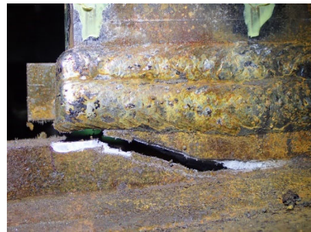
(d)+1 サイクル<破断> (西ダイアフラム側)
