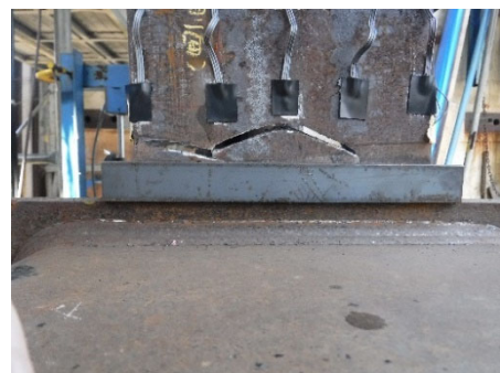
(h)－20 サイクル<破断> 西面溶接部
