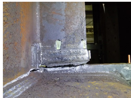
(f)+16 サイクル<破断> (西ダイアフラム側)
