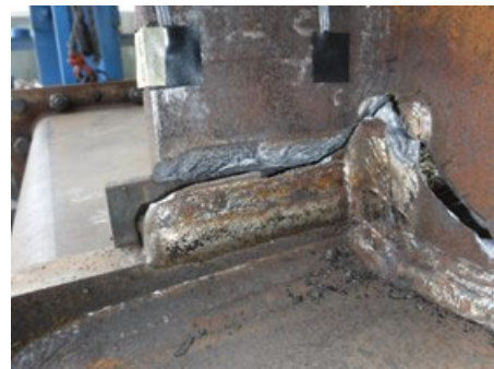
(d)－22 サイクル<破断> 南西溶接部
