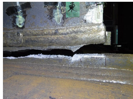
(f)-11 サイクル<破断> (東ダイアフラム側)
