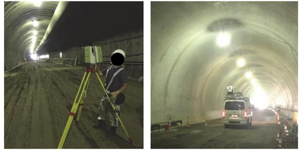
図-4 TLS、MMS の計測状況
