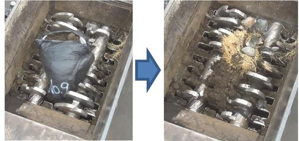
写真-4 二軸破砕機による破砕試験状況
