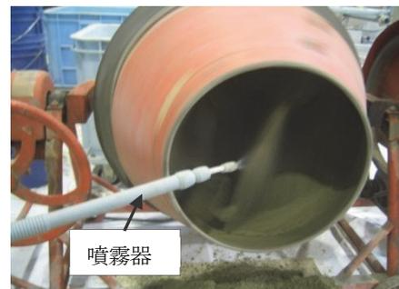
写真-1 模擬セシウム汚染土壌の調製
