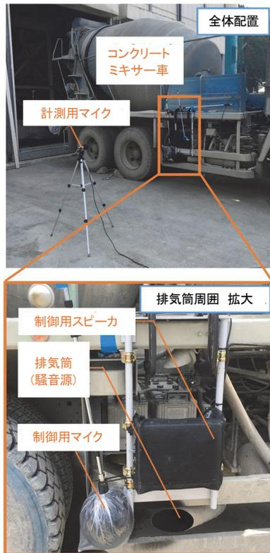
写真-1 アクティブ消音システムの適用状況
