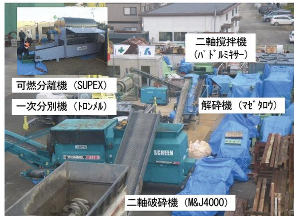
写真-3 実証試験における機器配置状況
