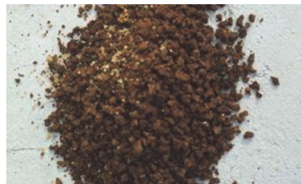
写真-1 鉄バクテリア汚泥の外観
