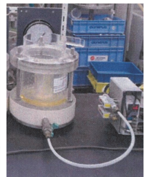
写真-1 透気試験状況
