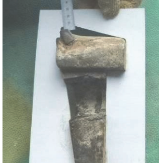
写真－7 ビット摩耗量測定
