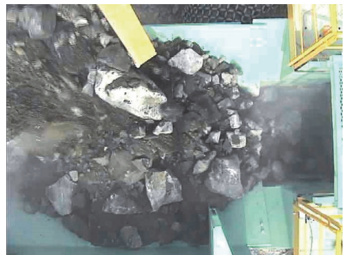
写真-3 直接投入直後の二次クラッシャーのホッパー内の状況（2連試験）
