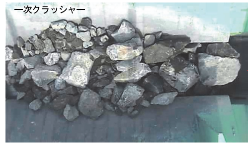
一次から二次クラッシャーへ投入
