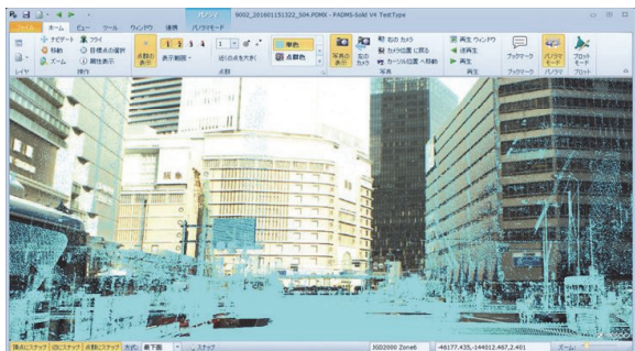
図-14 MMS取得データ (点群+写真)
