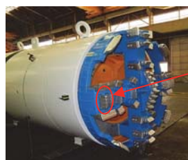
写真-4 シールド機に装備したスタミナビット
