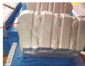
写真-4 シールド機に装備したスタミナビット
