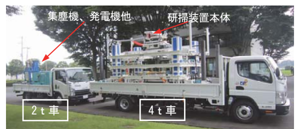
写真－1 天井用車載型乾式研掃装置
