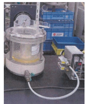
写真-1 透気試験状況
