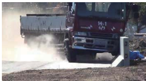
写真－2 (1) プレキャスト高欄・試験状況（条件A）
