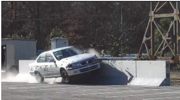
写真一 5 車両衝突試験状況 (条件 B)
