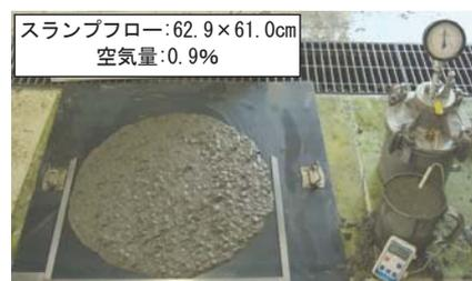
写真-1 フレッシュコンクリートの試験状況
